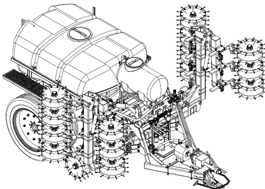
Рис. 1а Инъектор полевой "HARRIER" (ИП-10 "Лунь"). В транспортном положении
