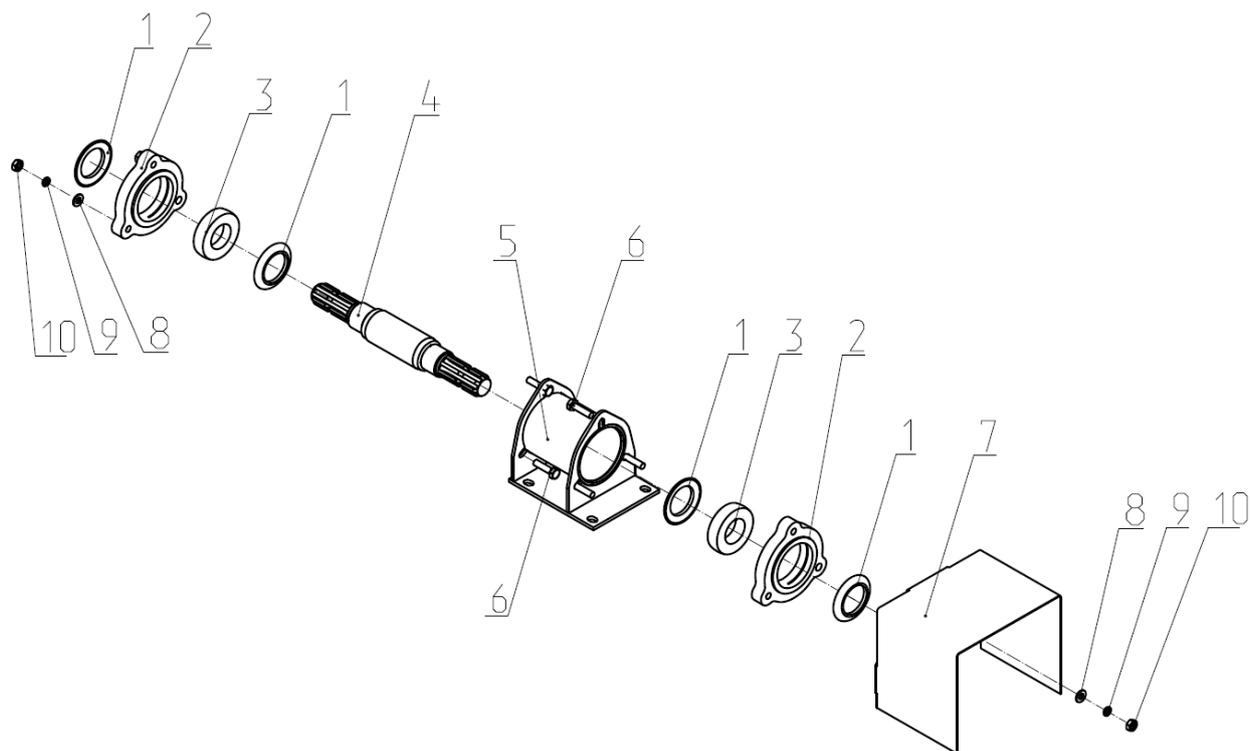
Рис.13 Промежуточная опора.
