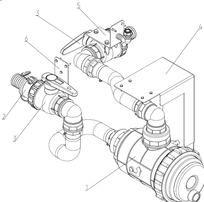
Рис.16 Устройство для заправки
