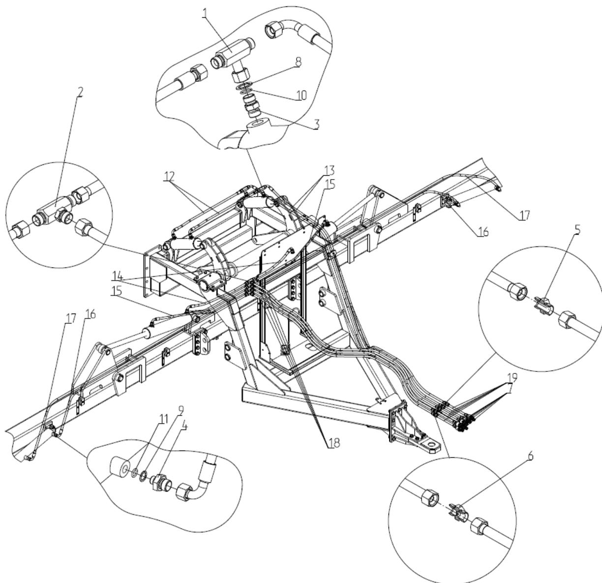
Рис. 18 Гидравлическая система
